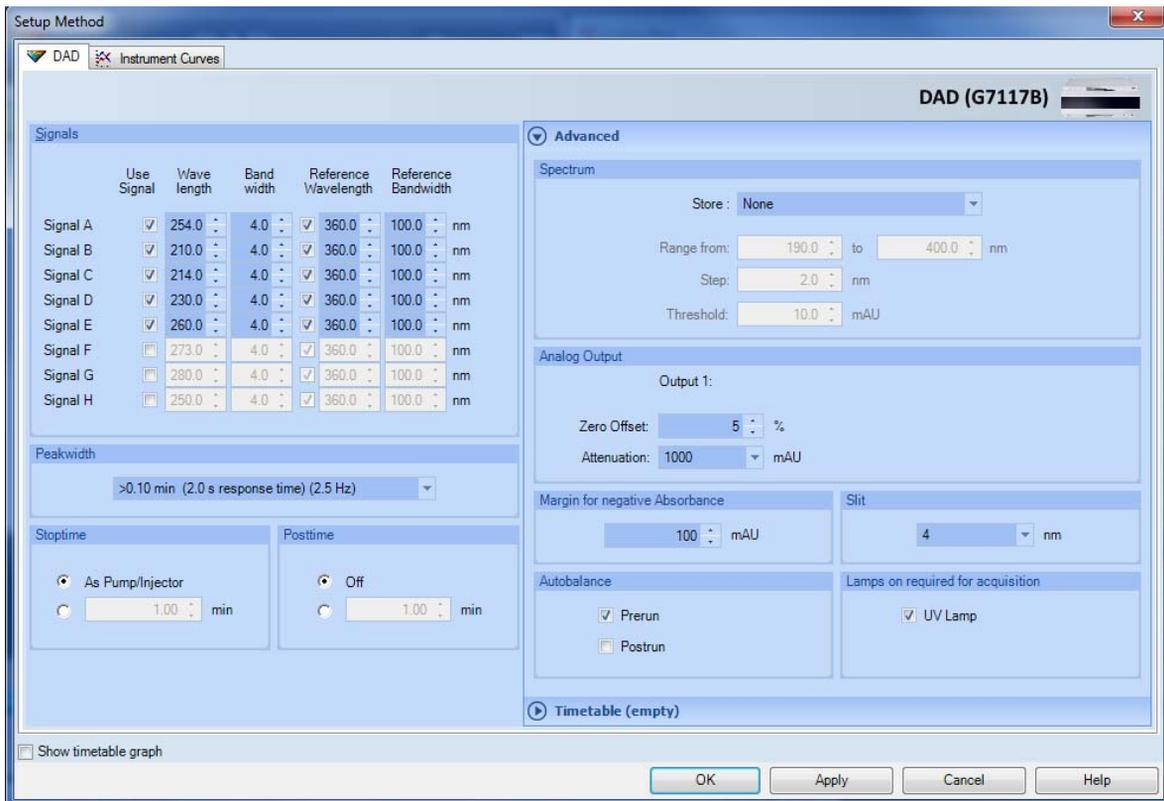
**Figure 12** Method parameter settings
